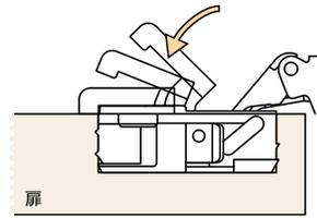
※取りはずし方法:②の図の矢印の反対方向より
